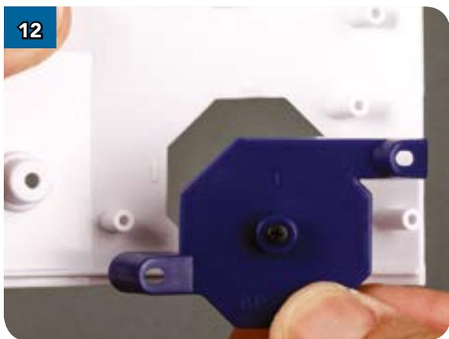
12 Поднесите конструкцию, собранную по инструкциям шагов 4–6, к восьмиугольному отверстию в панели так, как показано на фотографии, и установите её на место.
