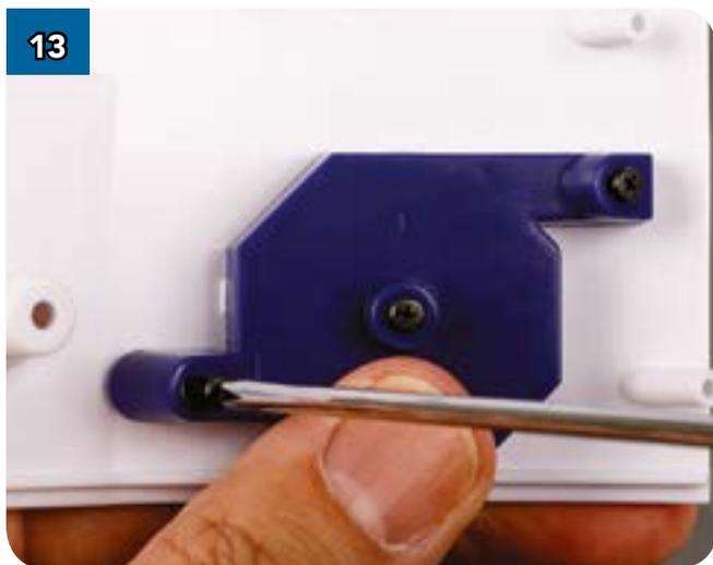
13 Закрепите конструкцию двумя чёрными саморезами 2,3 x 6 мм.
