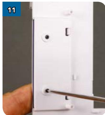
11 Закрепите конструкцию двумя чёрными саморезами 2 x 4 мм.
